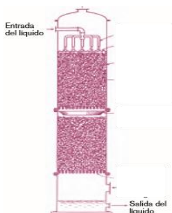
Figura 3.10: Filtro con relleno de toba zeolitizada de San Andrés.
