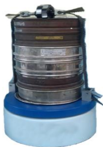
Figura 2.3: Criba vibratoria y juego de tamices.
