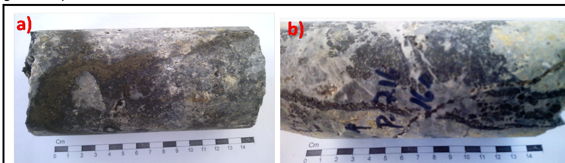
Figura 4.4. Muestras de perforación a columna de diferente profundidad. Izquierda, a) P-7.17 alteración tipo sílice masiva con pequeñas oquedades y vetillas de sulfuros diseminados (pirita, esfalerita) y oquedades rellenas por caolín y drusas de cuarzo cristalino; b) P-7.16 silicificación masiva con vesículas rellenas de alunita y caolín, también se observa vetilla y grietas rellenas con sulfuros (esfalerita y pirita).
