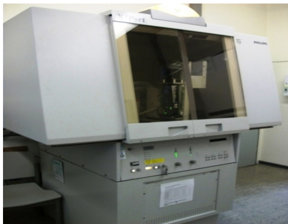
Figura 3.2. Fotografía del equipo de difracción de rayos-X, marca PANalytical modelo X'PERT-3.
