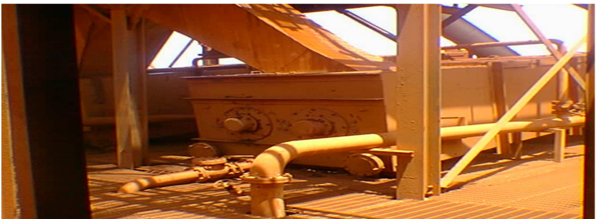
Figura 8: Lavadoras de ejes y paletas.
