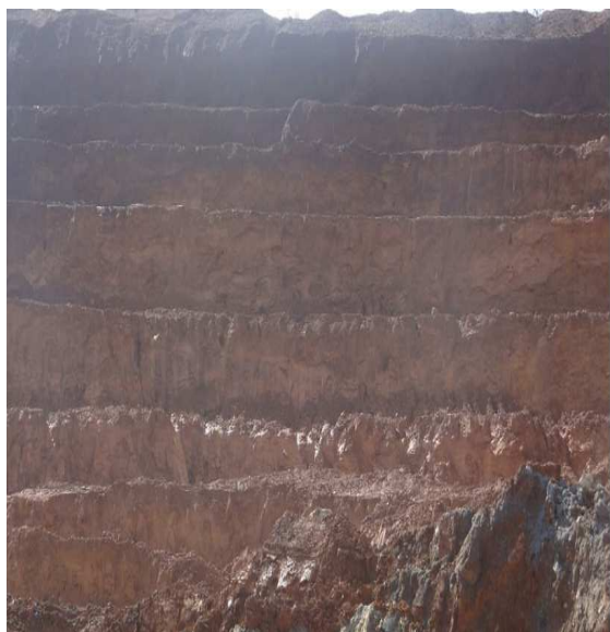
Figura 17: Perfil geológico con más de 15 m de horizonte limonítico.
