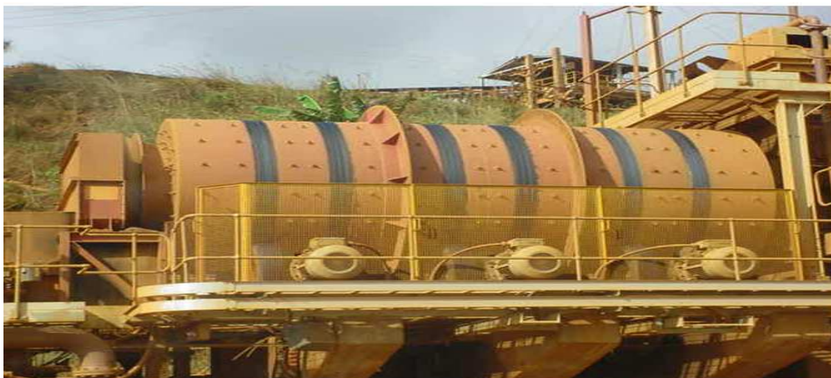
Figura 10: Cilindro lavador de rechazo.
