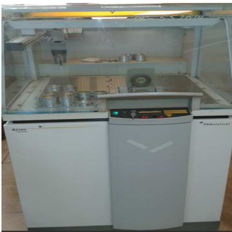
Anexo 20: Espectrómetro de Fluorescencia de rayos X.
