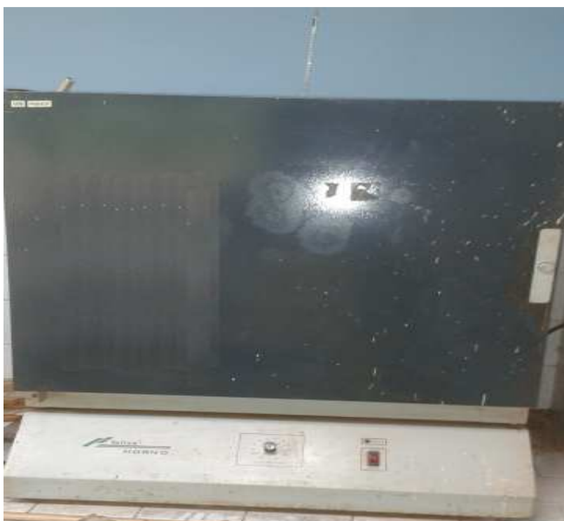
Anexo 19: Horno Felisa, con rango de temperatura de 0 a 300 °C.
