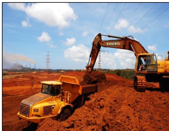
Figura 5. Sistema de extracción y transporte del mineral laterítico, Fonseca (2024b).
