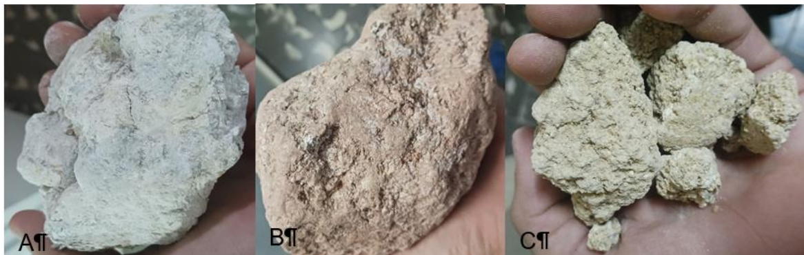
Figura 6: Materiales arcillosos residuales de la explotación del yacimiento de caolín Dumañuecos, A: arcillas caoliníticas blancas; B: residuos arcillosos rojos; C: materiales arcillosos de la zona de destape
