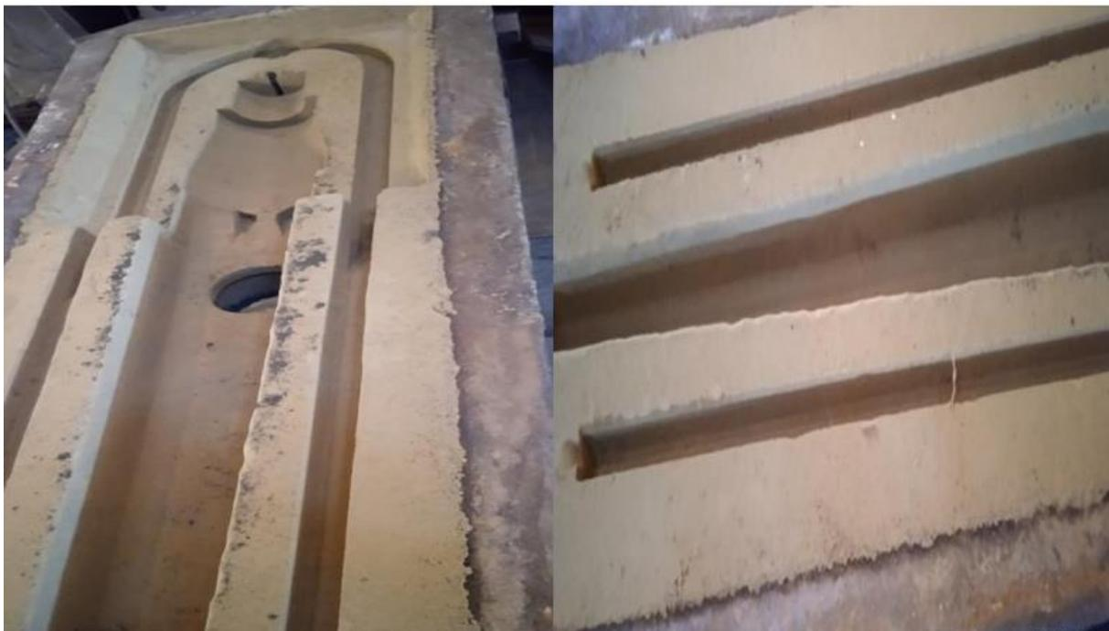
**Figura 21.** Aplicación de pinturas a base de rechazo serpentínico, en los moldes de los brazos de hornos de reducción de acero HK-40. **Fuente:** (Pérez Larduet & de la Paz Cuello, 2024).
