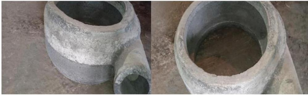
**Figura 22.** Bomba pintada empleando como relleno el rechazo serpentinitico de la tecnología HPAL
