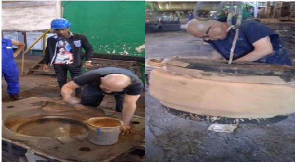
**Figura 20.** Aplicación de las pinturas preparadas a base de rechazo serpentínico, en los moldes de bomba de hierro fundido. **Fuente:** (Pérez Larduet & de la Paz Cuello, 2024).
