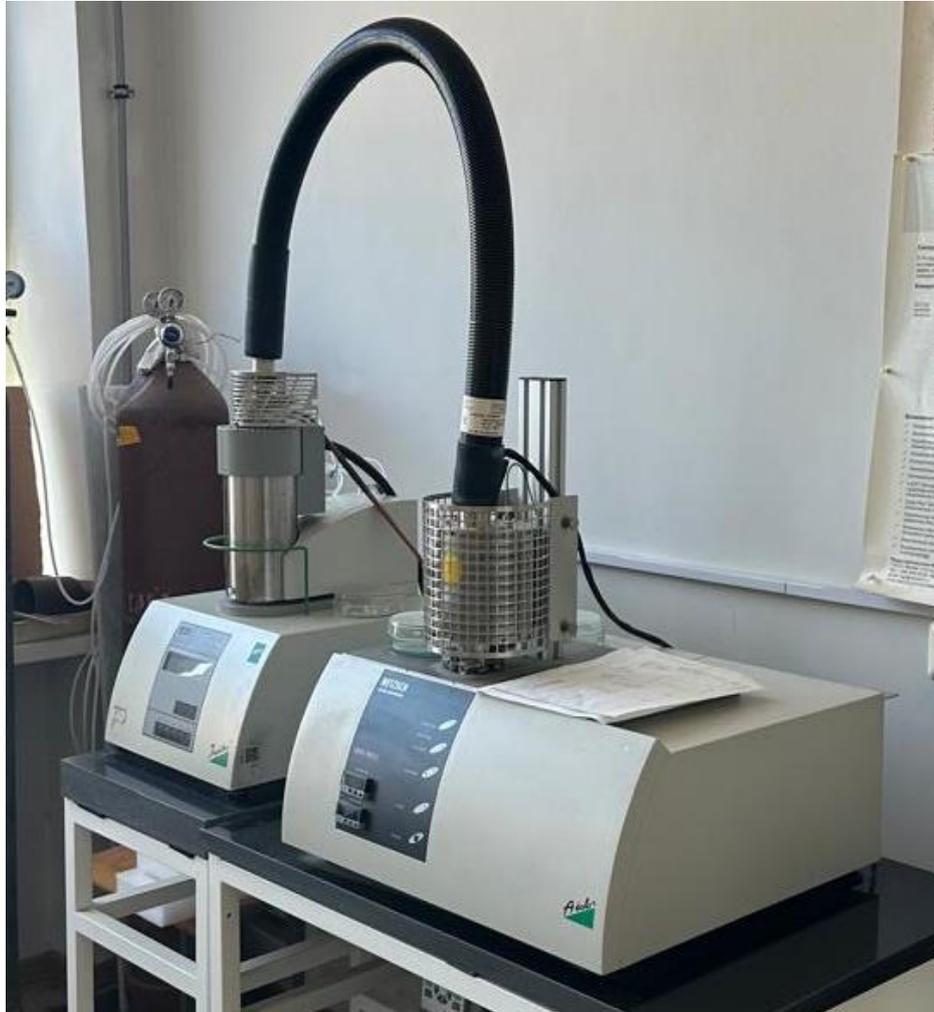
**Figura 10.** Equipo NETZSCH, utilizado para realizar el análisis térmico. **Fuente:** (Ferrer Batista, 2024).
