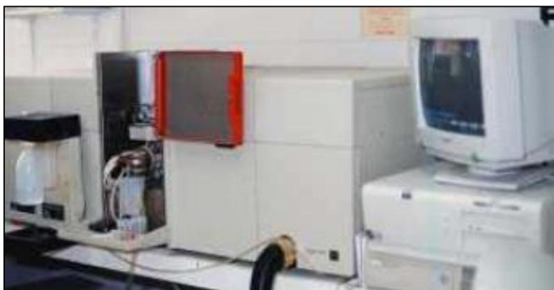
**Figura 7.** Equipo de Espectroscopia de Absorción Atómica empleado en los análisis químicos. **Fuente:** (CEDINIQ, 2022).
