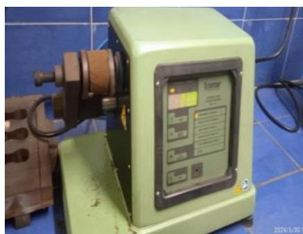
**Figura 15.** Permeámetro para determinar la permeabilidad en las mezclas de moldeo obtenidas a partir de rechazos serpentínicos
