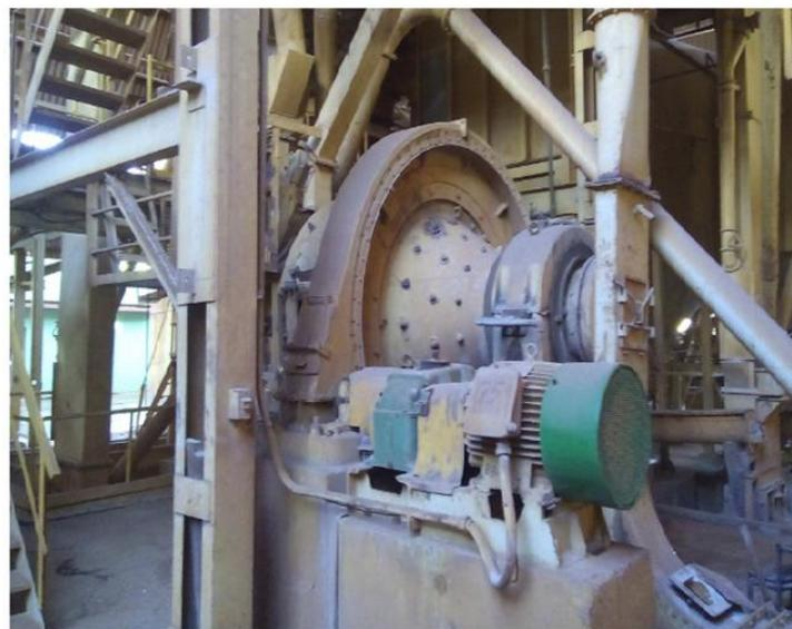
**Figura 12.** Molino de bolas empleado para la molienda de los rechazos serpentínicos.
