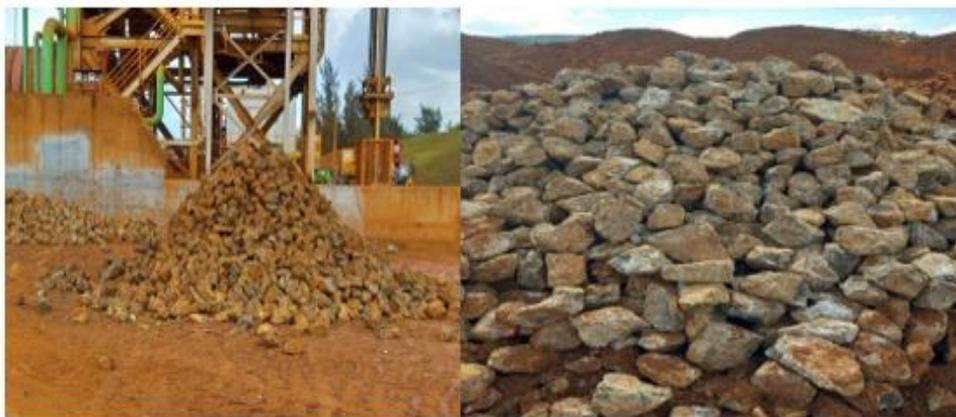
**Figura 5.** Rechazo serpentinitico de la nueva planta de pulpa de Moa Nickel S.A
