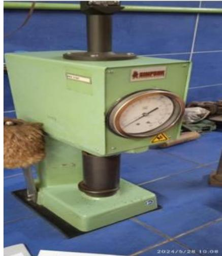
**Figura 16.** Máquina de compresión para evaluar la resistencia de compresión de las mezclas de moldeo.
