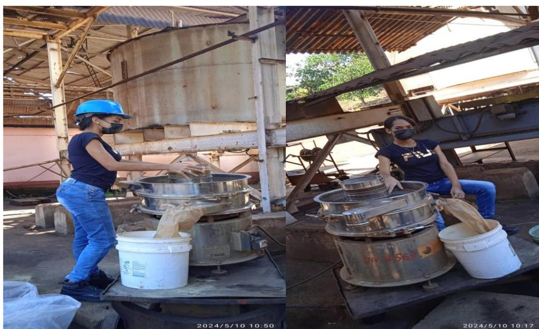
**Figura 18.** Equipos empleados en el CEDINIQ para la clasificación de los rechazos serpentiniticos.
