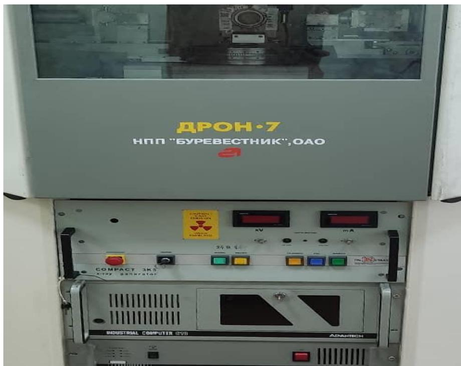
**Figura 9.** Difractómetro de Rayos X DRON – 7 empleado para los análisis mineralógicos.
