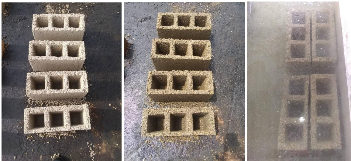
Figura 3.1. Bloques huecos de hormigón elaborados con 50 % de tobas zeolitizadas por cemento Portland P-35.
