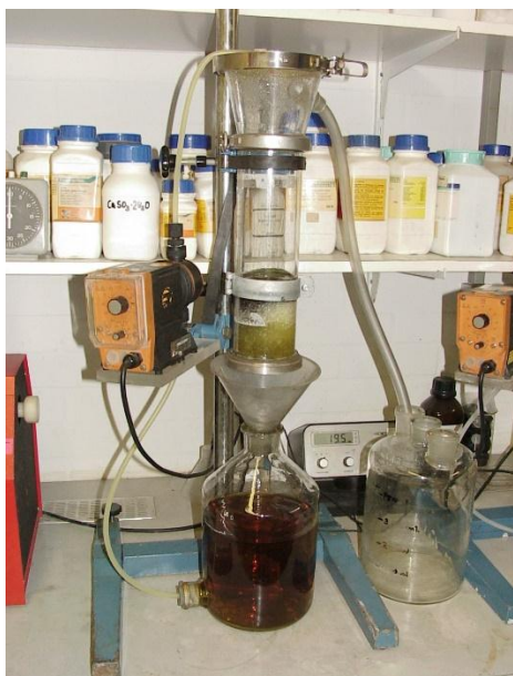
Figura.4: Instalación para la lixiviación con ácidos orgánicos.
