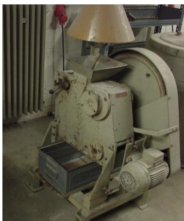
Figura.5: Triturador empleado para preparar el material inerte.
