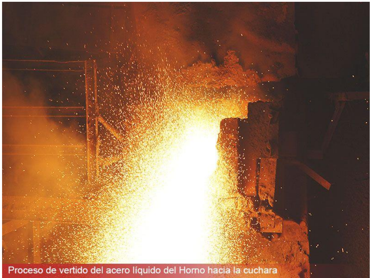
Anexo 3. Proceso de vertido del acero líquido del Horno hacia la cuchara.
