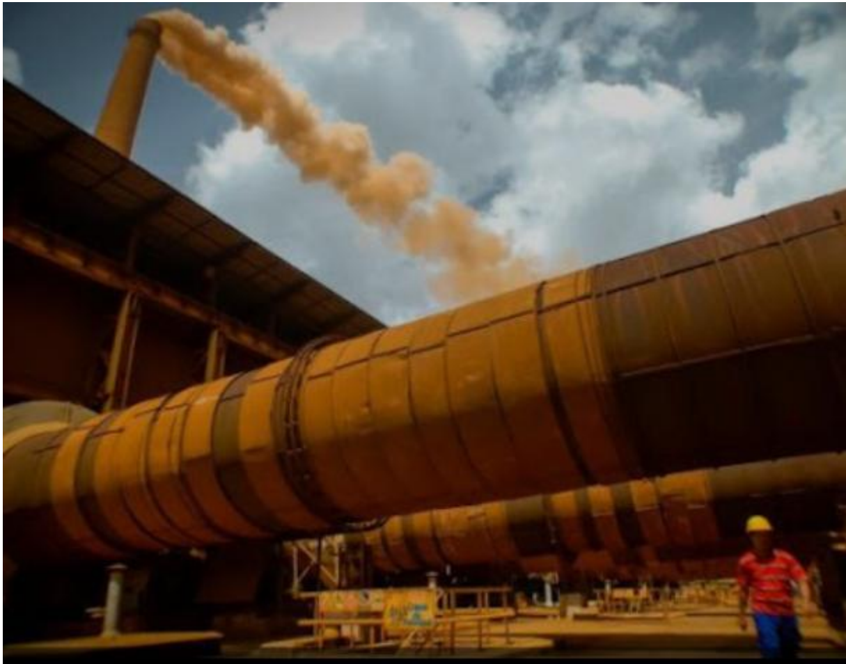
Foto 1 Hornos de tambor rotatorio de la UBP Calcinación y Sínter
