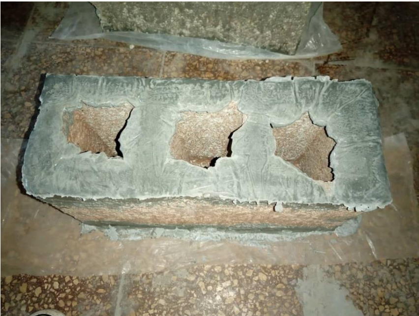
Figura 2.6. Recubrimiento de los bordes del bloque con una capa de cemento P-35
