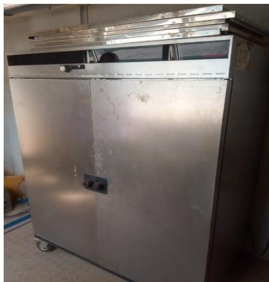
**Figura 5.** Estufa utilizada para el secado de las muestras.
