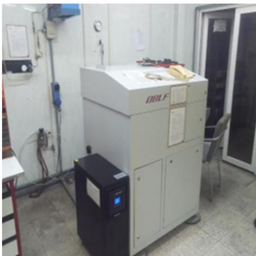
**Figura 12.** Espectrómetro de masa empleado en la caracterización química de los metales obtenidos.
