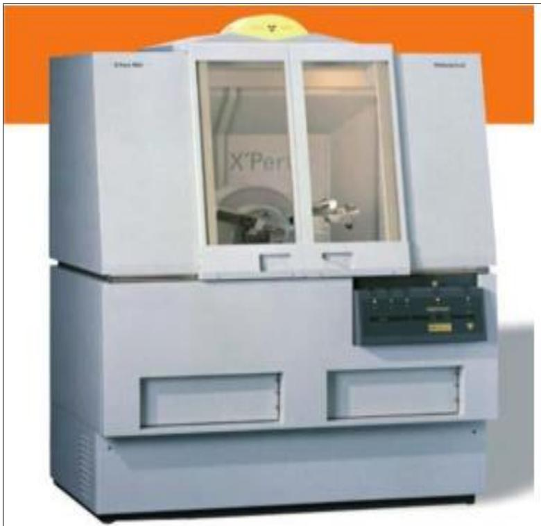
**Figura 11.** Equipo de difracción de Rayos X empleado en la caracterización mineralógica.
