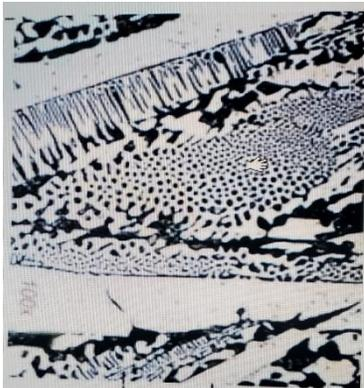
Figura.5: Muestra de arrabio con níquel (NPI), contenido de 1,27 %, de níquel.
