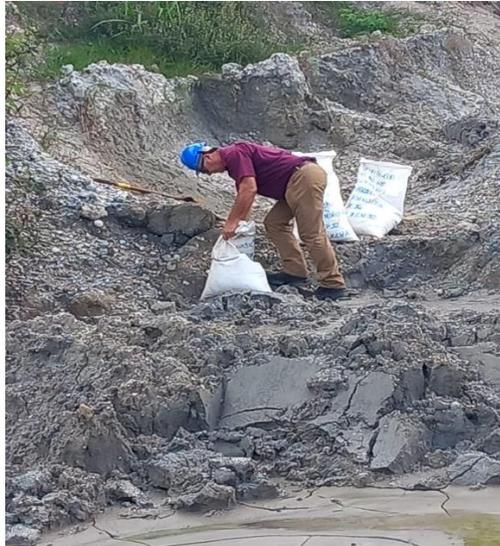
**Figura 4.** Proceso de toma de muestras del cieno carbonatado.
