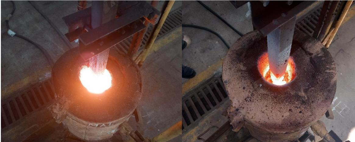
**Figura 9.** Horno de arco eléctrico empleado en las pruebas de fusión reductora.
