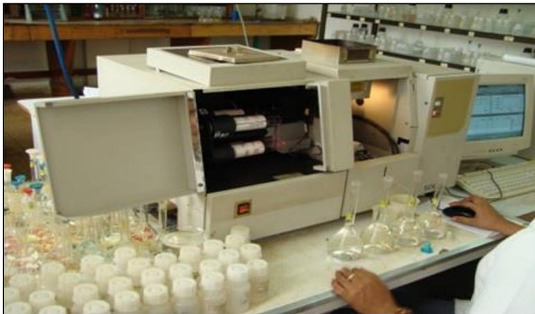
**Figura 10.** Equipo de espectrometría de absorción atómica empleado en la caracterización química.
