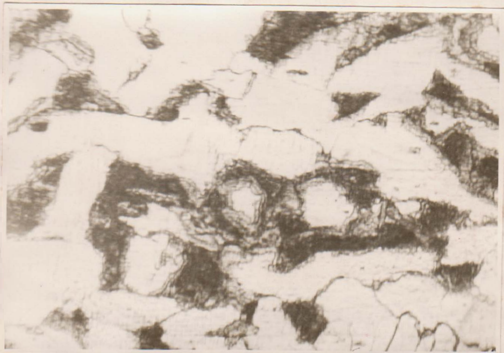
Fig. 9. Estructura ferrítica perlítica del acero 20 K.
