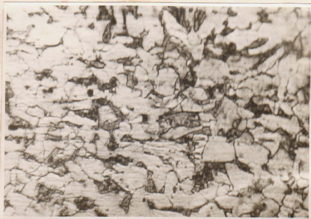
Fig. 5. Estructura Metalográfica del metal base del acero 09G2S.
