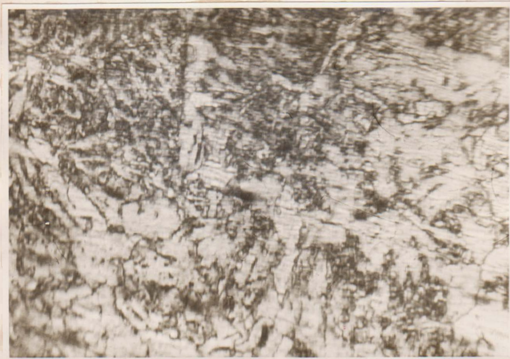
Fig. 7. Zona de la soldadura. Donde se - desarrollan las grietas.
