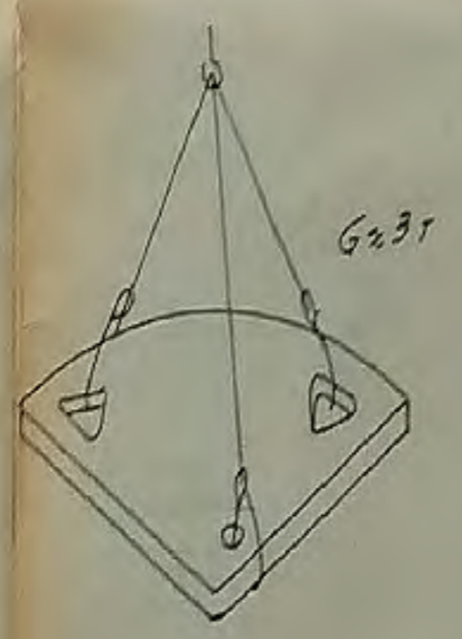
ESQUEMA 8 ESLINGADO DE LA CHIMENEA
