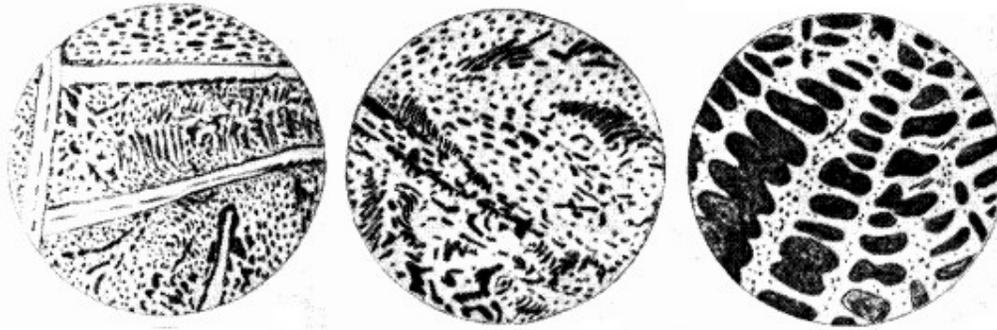
Figura 1.6. Estructuras de la fundición blanca.
