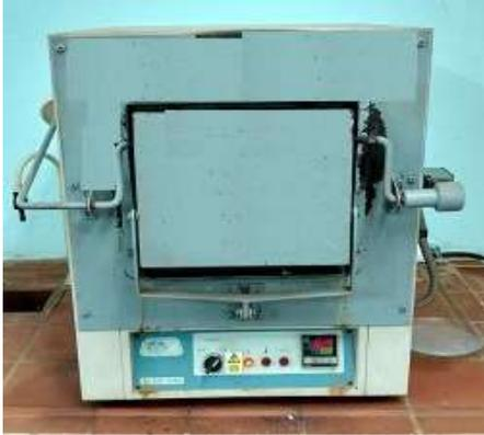
Figura 2.3. Horno de mufla (TT de recocido).
