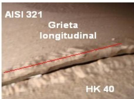
Figura 2. Unión por soldadura del tramo V del transportador.
