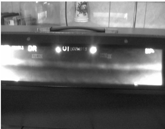
Figura 3.9. Radiografía para electrodo E 312 - 16.
