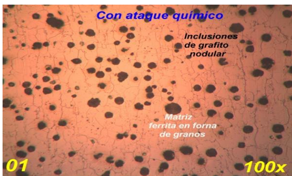
Figura.3.1.Muestra 01 con ataque químico (65 Hz y 2 mm)
