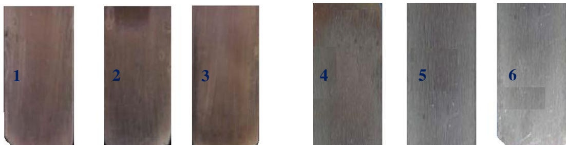
Figura 2.4. Corte de las muestras (para tratamiento de temple y de alivio de tensiones)
