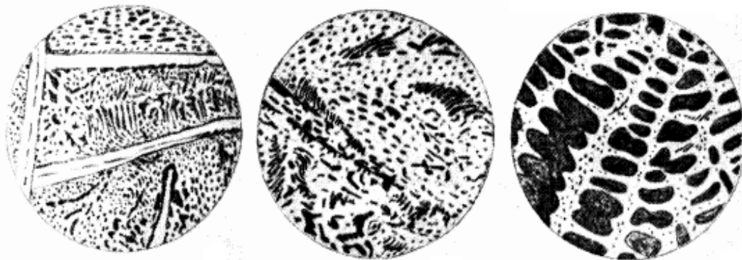
Figura 1.5. Estructuras de la fundición blanca. Fuente: Rojas et al. (2000).
