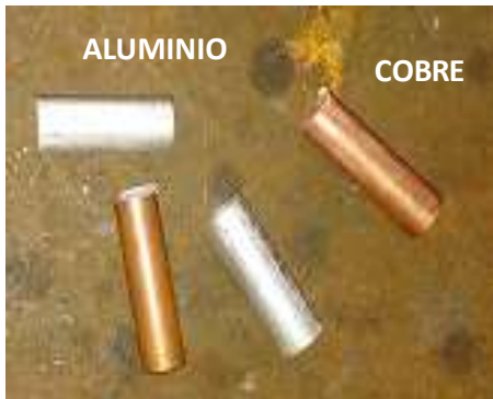
Figura 2.5. Muestras para el proceso de soldadura.
