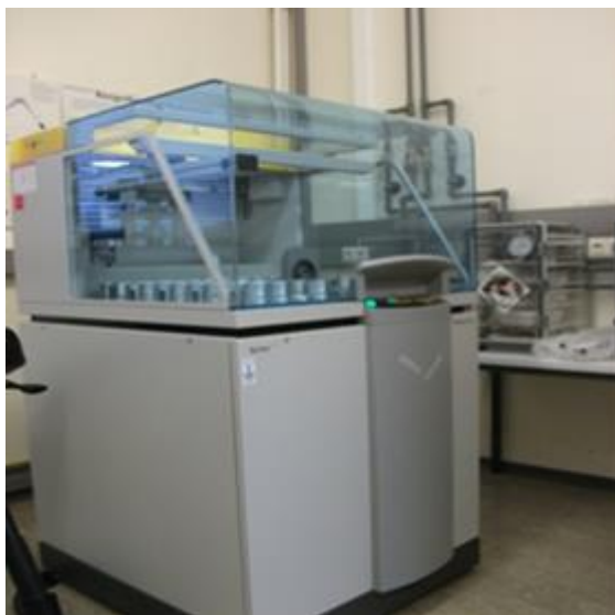
Figura 2.5. Equipo de fluorescencia de rayos X, Axios.
