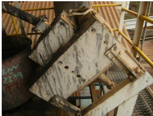
Figura 6: Electroimán SJ-1, primera etapa de Lixiviación.
