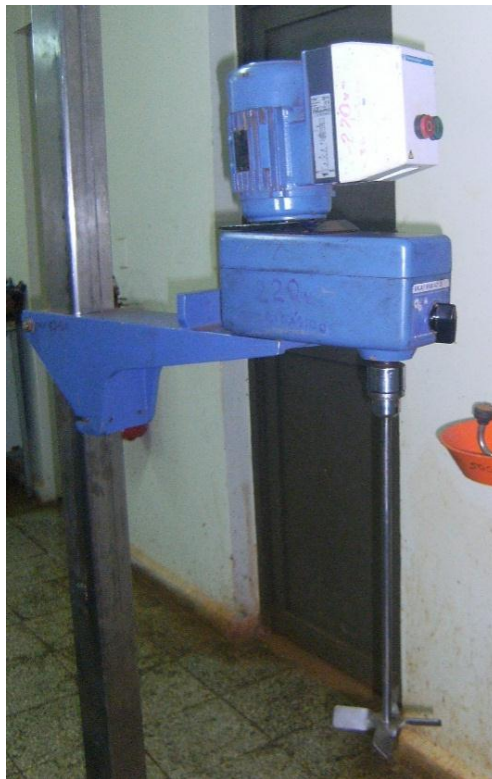
Figura 8: Agitador y mecanismo de agitación para la preparación del floculante.
