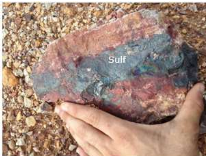
Figura 2. Muestra de roca con elevado grado de oxidación en su parte exterior y presencia de mineralización sulfurosa (Sulf) alterada en su interior.
