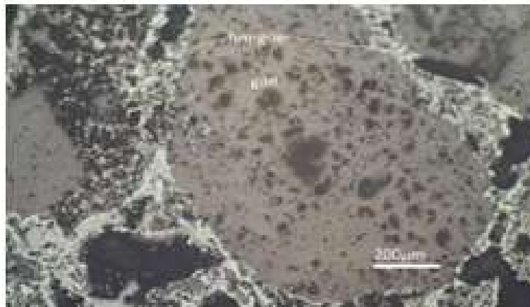
Figura 12. Agregados anhedrales de hematita - goethita (hm-goe) bordeando los minerales de ganga, con textura de cemento. Muestra S-2
