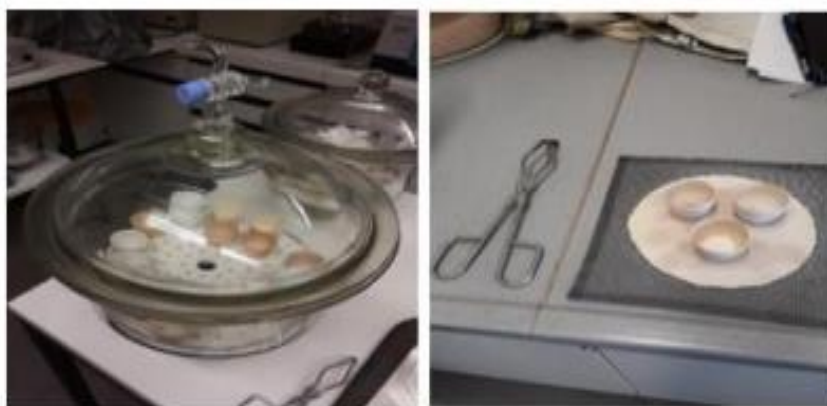
Figura 15: a) Desecadora de vidrio, b) muestras en crisoles de porcelana.
