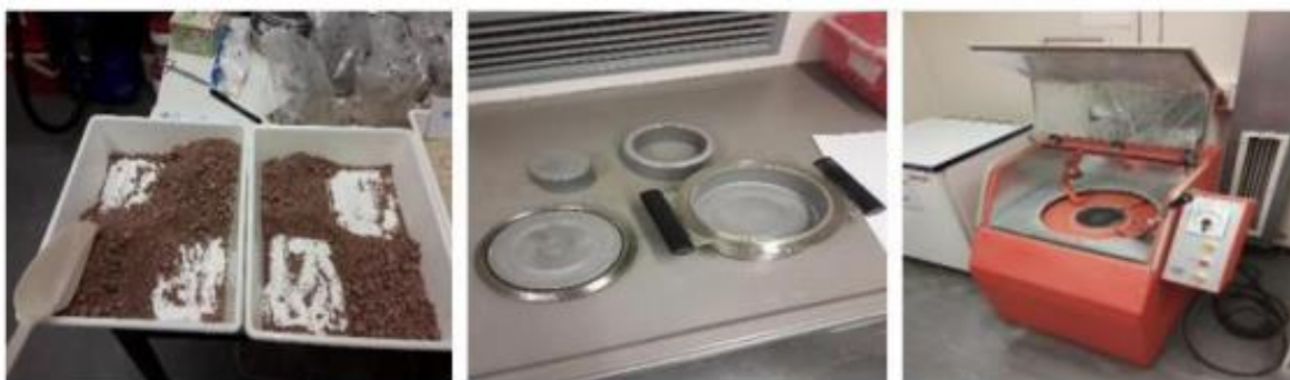
Figura 11: a) cuarteo en bandejas, b) accesorios del molino de anillos, c) molino de anillos.
