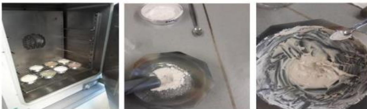
Figura 12: a) Mufla con ventilación interna, b) mortero de ágata, c) pasta resultante luego de la molienda en húmedo.
