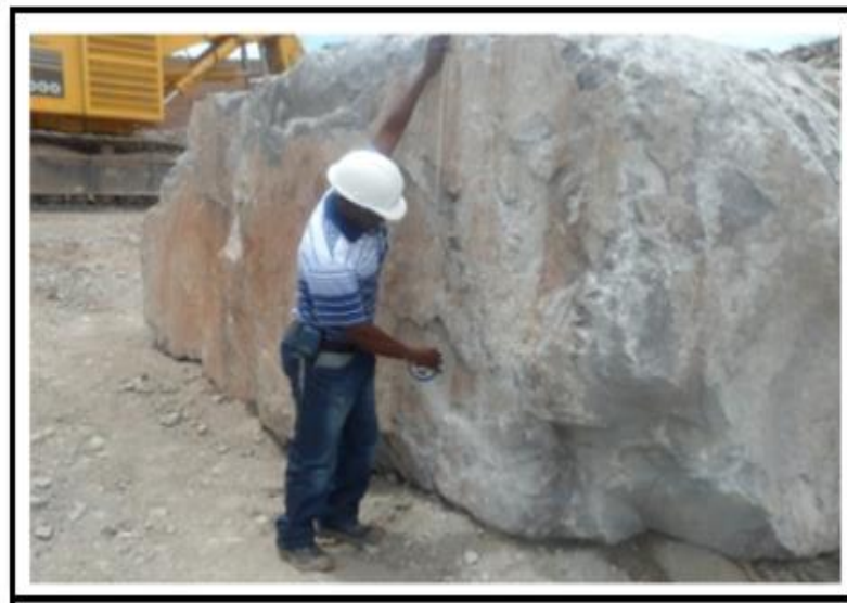
Figura 3. Fragmento de roca sobremedida resultante de la voladura.
