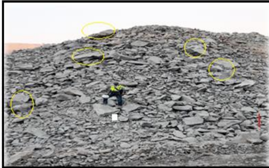
Figura 32. Registro fotográfico de las rocas sobredimensionadas en la voladura experimental con el índice de extinción de las tensiones n = 1,40 .
