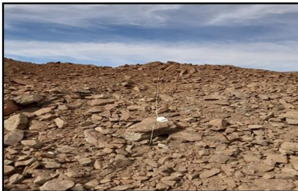
Figura 34. Registro fotográfico de las rocas sobredimensionadas en la voladura experimental con el índice de extincion de las tensiones n = 1,50 .
