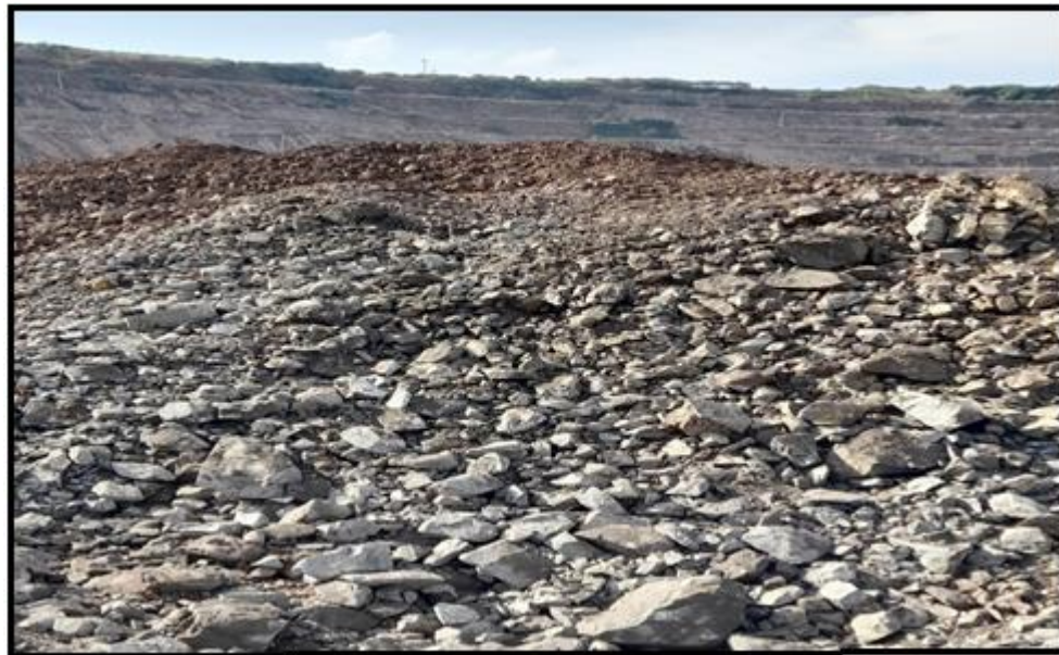
Figura 33. Registro fotográfico de las rocas sobredimensionadas en la voladura experimental con el índice de extinción de las tensiones n = 1,45 .
