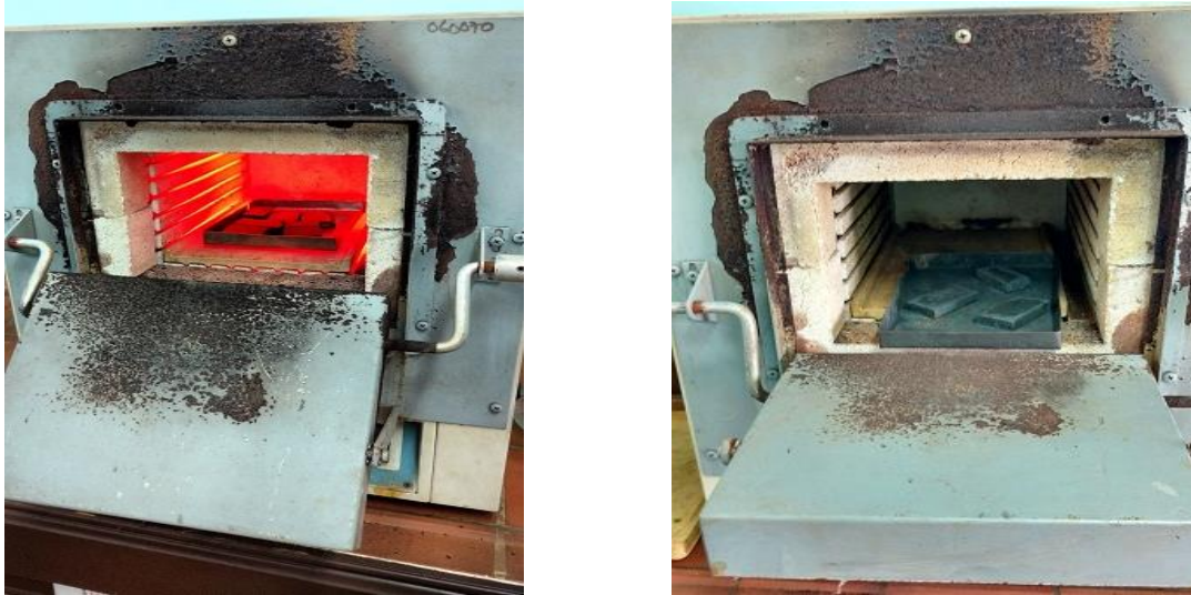
Figura 2.7. Horno de mufla (TT de austenizado y austempering).
