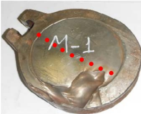
Figura 2.6. Barrido de dureza en la superficie de la cuña.
