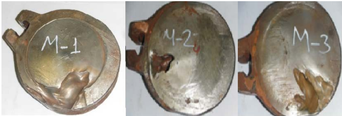
Figura 2.3. Defectos presentes en las cuñas después de una campaña.
