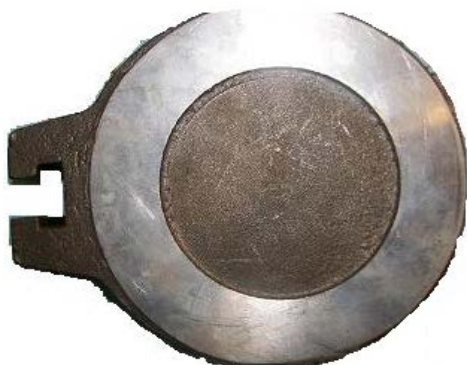
Figura 2.2. Cuña de la válvula en estado forjada.
