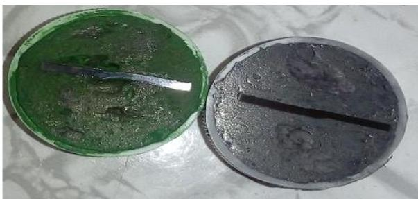
Figura 2.3. Montaje de la muestra en resina epoxi ROYAPOX 5050.
