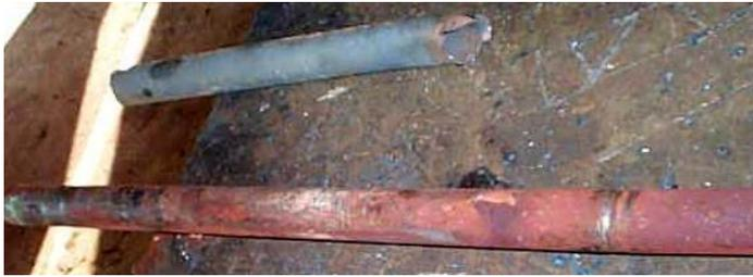
Figura 2.2. Área de selección de las muestras en la línea de ácido  $H_2SO_4$  agrietada.
