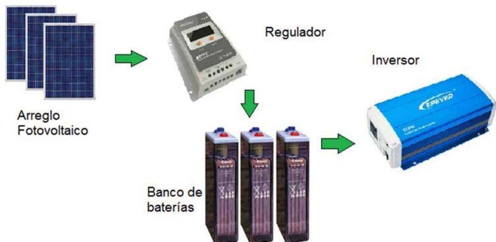
Figura 3.10. Esquema del SFV propuesto para las viviendas aisladas de Santa Rita
