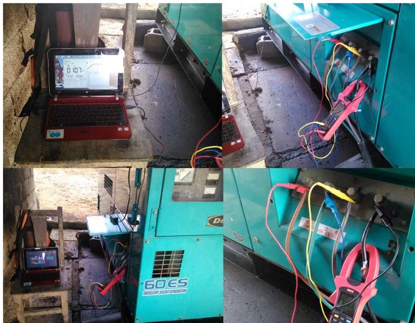
Figura 3.2. Conexión del medidor de potencia PCE-UT232
