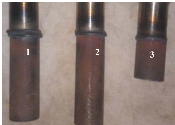
Figura 2.5. Probetas obtenidas luego del proceso de soldadura.
