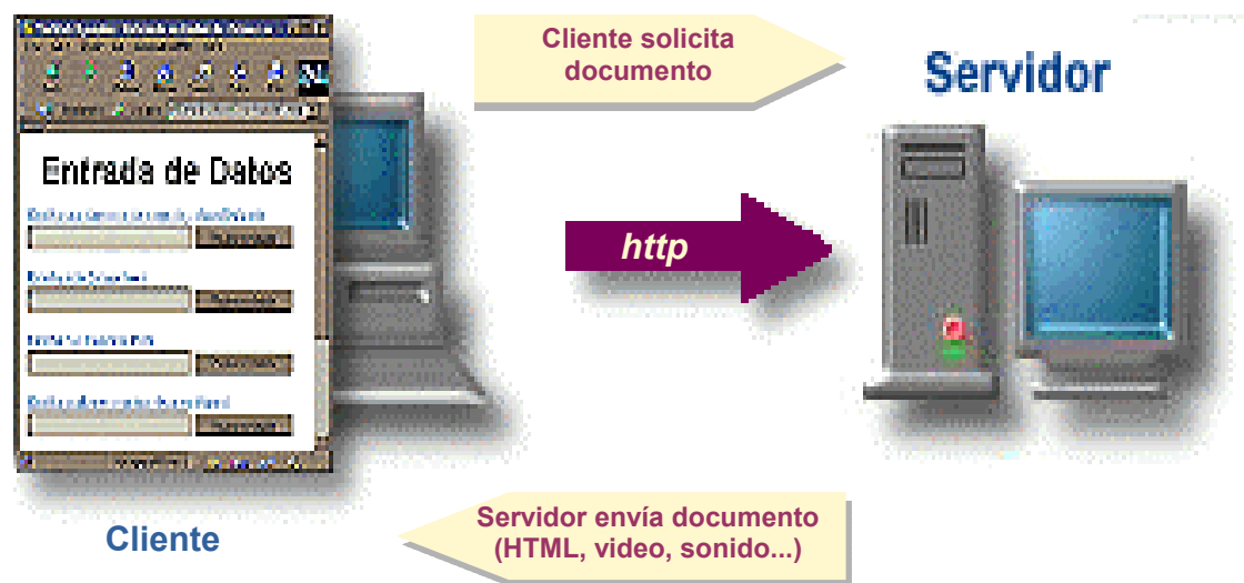
Figura 1.1 Esquema de funcionamiento de un servidor y un cliente Web.
