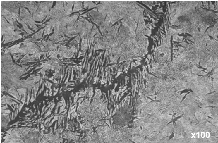
Figura 2.5. Muestra patrón de un acero hipoeutectoide.
