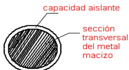
Fig. 1.14. Sección transversal de un alambre.
