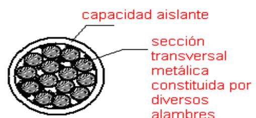
Fig. 1.15. Sección transversal de un cable.
