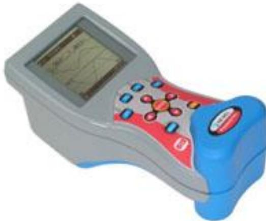
Figura 2.3 Analizador de Redes Power Q Plus
