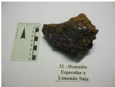
E: muestra RX 11 - Hematite Especular y Limonita.
