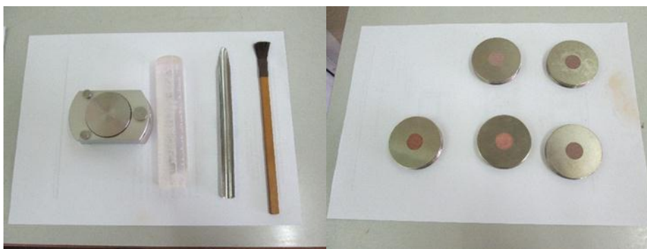
Figura 15. Foto de los utensilios y materiales utilizados en la preparación de la hoja para procesarlas por la técnica analítica DRX.
