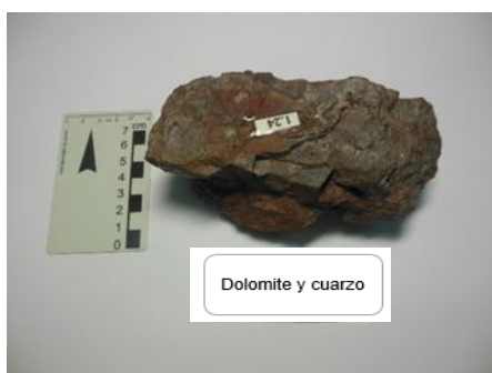
A: muestra RX 8 - dolomite y cuarzo
