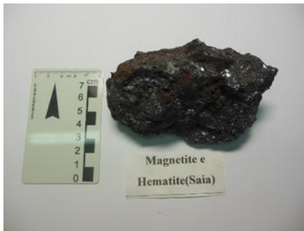
A: muestra RX 1 - Magnetite y Hematita
