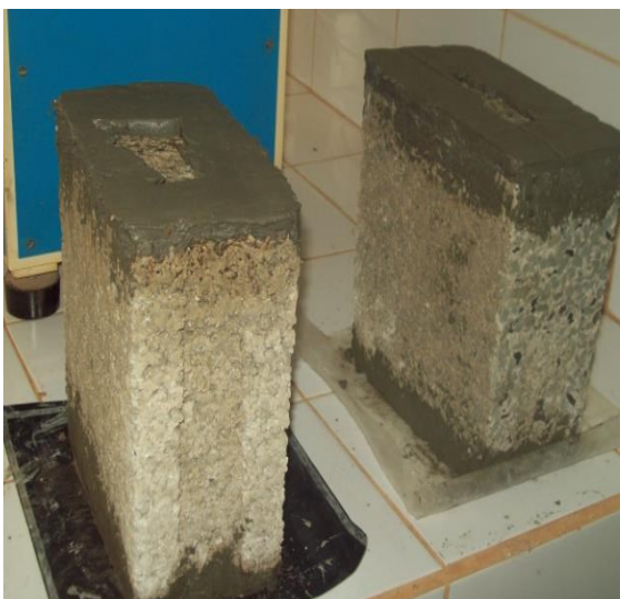
Figura 2.8 Muestras de los bloques con el capping.
