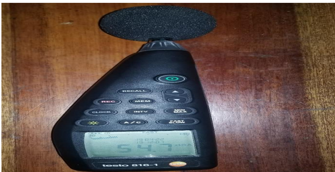
Figura 2. 2. Sonómetro utilizado en las mediciones del ruido ocupacional.
