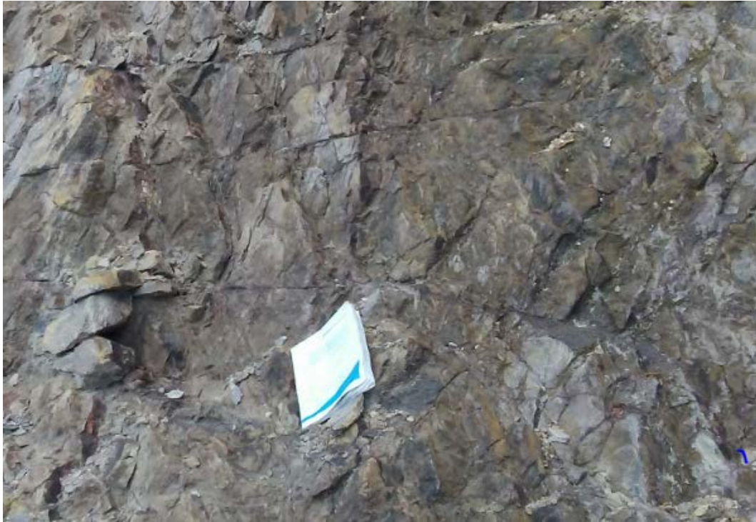
Figura 7 Persistencia de las discontinuidades en el yacimiento
