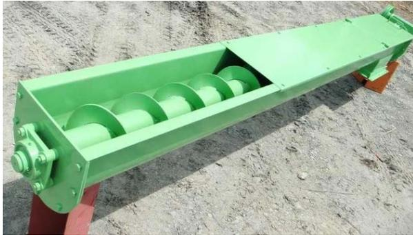
Figura 1.4: Transportador de tornillo sin fin Fuente: Alexandrov (1976).
