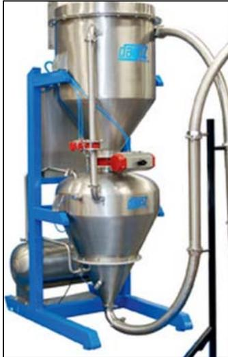
Figura 1.2: Transportador neumático Fuente: Alexandrov (1976).
