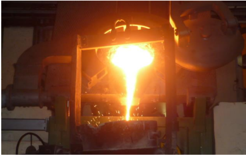
Figura 2.2. Colado del acero.
