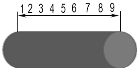
Figura 2.7. Barrido de dureza longitudinal en las muestras fundidas y tratadas térmicamente.
