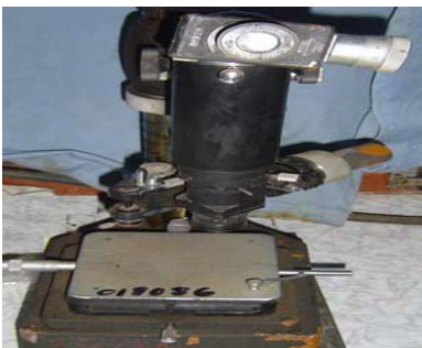
Figura 2.4. Microscopio utilizado para el ensayo de microdureza.
