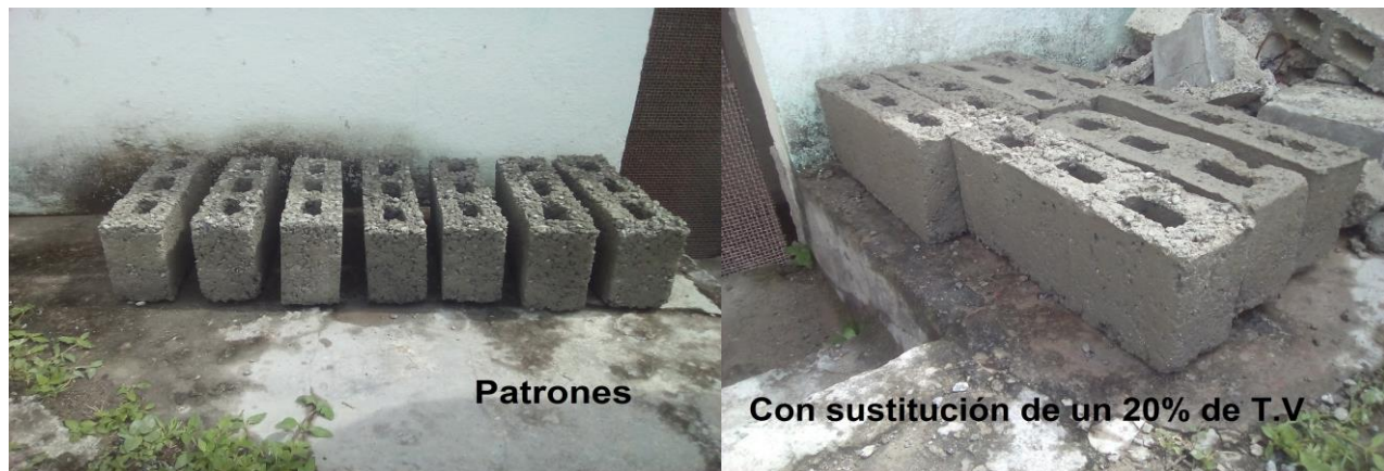
Figura 2.5 Bloques huecos de hormigón (40x10x20).
