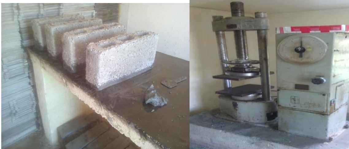
Figura 2.4 Recubrimiento de las caras del bloque y la prensa
