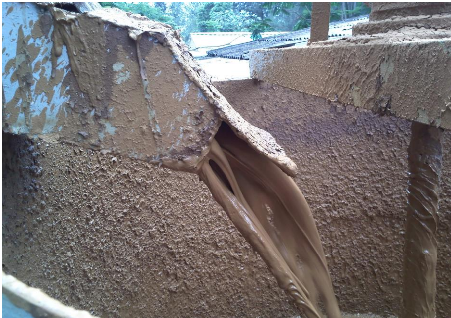
Figura 2. Pulpa laterítica con el uso del dispersante Flosperse 600.
