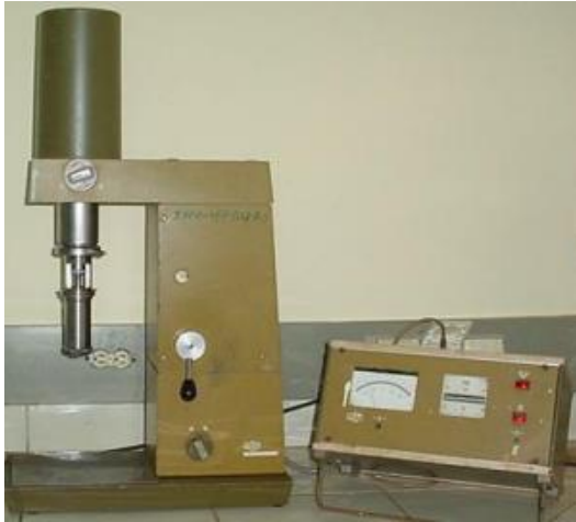
Figura 1. Viscosímetro rotacional de cilindros concéntricos RHEOTEST 2 y analizador de humedad RAD WAG.
