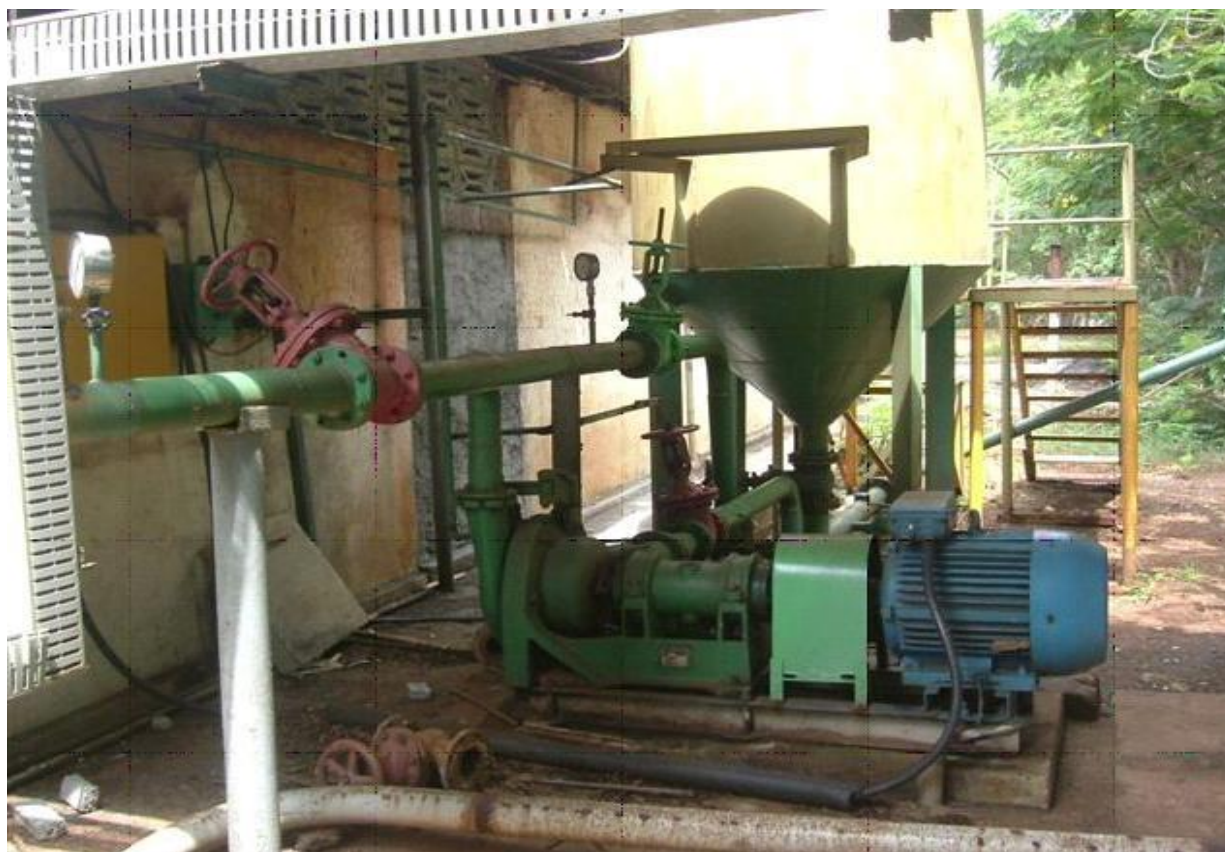
Figura 1: Esquema de la instalación de hidrotransporte del instituto superior minero metalúrgico de Moa.
