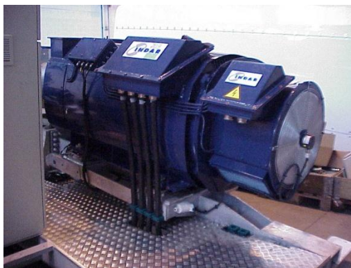
Figura 17 Vista del generador asincrónico.
