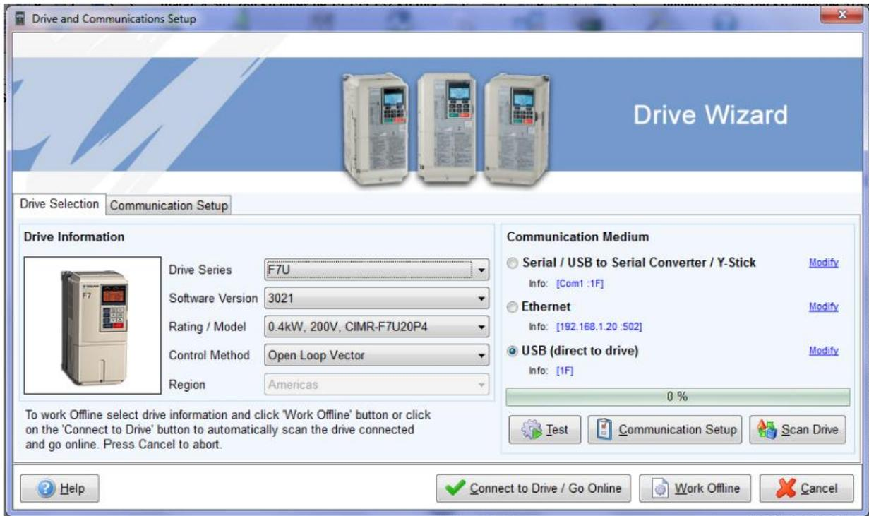
Figura. 2.10 ventana del programa Drive Wizard utilizando la comunicación USB.
