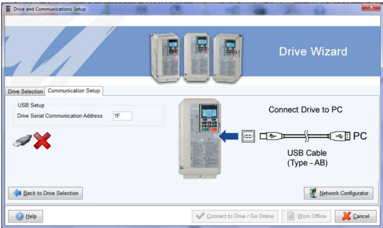
Figura. 2.11 ventana del programa Drive Wizard donde se muestra como realizar la comunicación USB.
