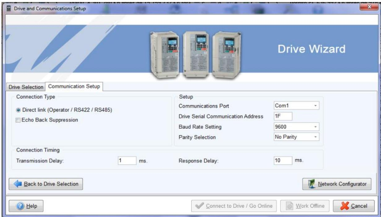
Figura.2.7 ventana del programa Drive Wizard con los parámetros a utilizar para lograr la conexión Modbus.
