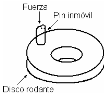
Figura 2.4. Esquema para realizar el ensayo de desgaste en la pulidora metalográfica.
