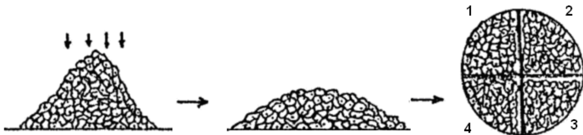
Figura 2.3. Método de cuarteo para la preparación de la muestra.
