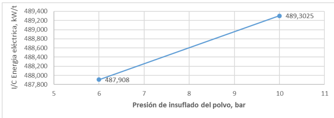
Figura3.16. Relación entre la presión de insuflado del polvo y el índice de consumo de energía eléctrica.
