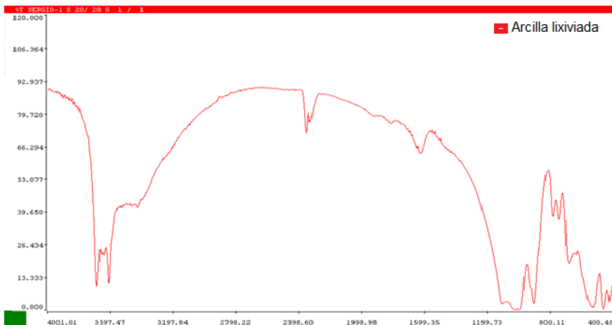
Figura 3.4 Análisis minerográfico de la arcilla obtenida después de la lixiviación.
