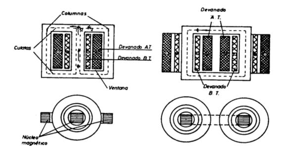
Figura 2.1 Vistas frontal y superior de núcleo acorazado.
